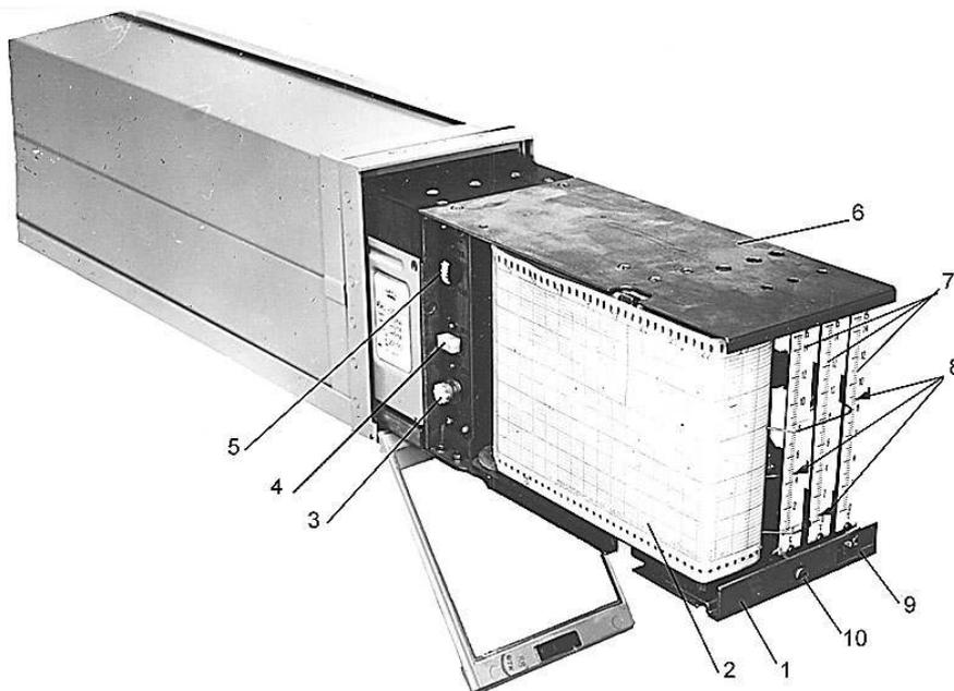
1 - ручка; 2 - лентопротяжный механизм; 3 – вставка плавкая; 4 – выключатель питания прибора; 5 - выключатель лентопротяжного механизма; 6 - шасси; 7 - шкалы исполнительные двигатели; 8 – указатели; 9 – индикатор; 10 – винт замка
