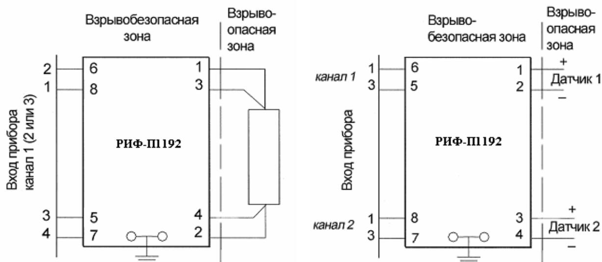
Рисунок Н.2 – Подключение датчиков, расположенных во взрывоопасной зоне через барьеры, устанавливаемые во взрывоопасной зоне
