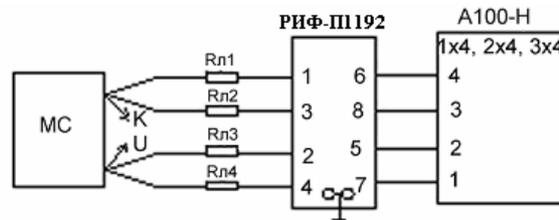
Рисунок 1.2 - Подключение магазина сопротивлений при определении основной погрешности показаний прибора с барьером искрозащиты
